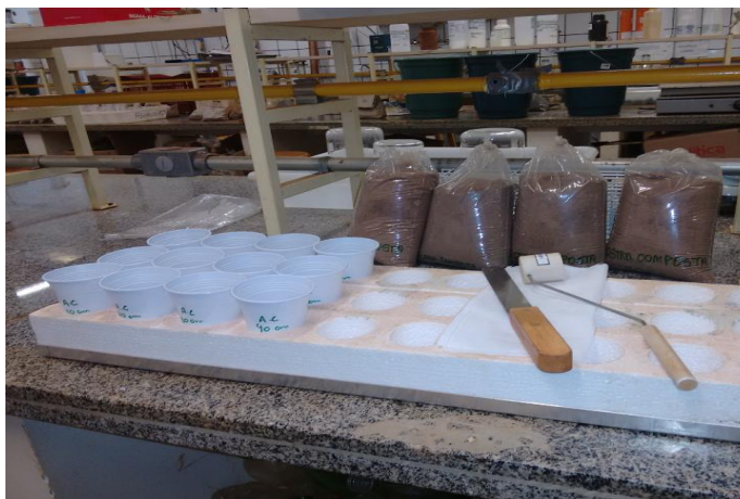
Figura 6. Determinação do pH em \text{CaCl}_2 – Laboratório Solos UFMS, 2015.
