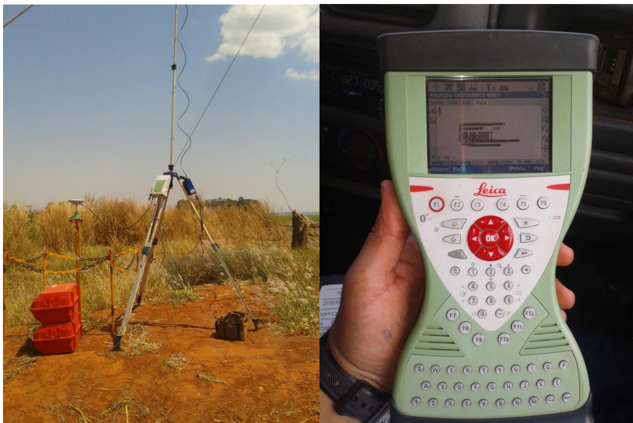
Figura 4: Base RTK utilizada para correção e receptor de sinais
