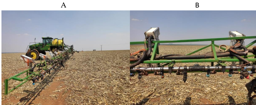
Figura 3. Ilustração do sistema Weed-it instalado no pulverizador autopropelido John Deere modelo 4730: imagem (A) sistema Weed-it em toda barra de pulverização, imagem (B) sensor de leitura Weed-it posicionado a frente da barra de pulverização e bicos com sistema PWM posicionado atrás da barra de pulverização.
